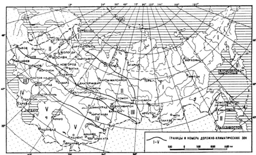
Дорожно-климатические зоны включают в себя следующие географические зоны: I - тундры, лесотундры и северо-восточную часть лесной зоны с распространением вечномерзлых грунтов; II — лесов с избыточным увлажнением грунтов; III — лесостепную со значительным увлажнением грунтов в отдельные годы, IV — степную с недостаточным увлажнением грунтов; V — пустынную и пустынно-степную с засушливым климатом и распространением засоленных грунтов.
