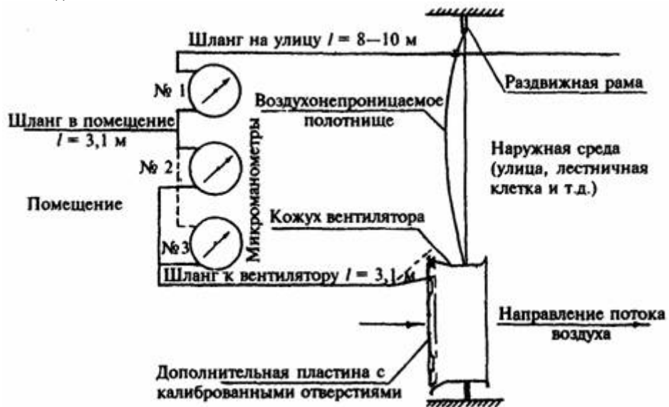
Рисунок 4 — Пластина с отверстиями к кожуху вентилятора
